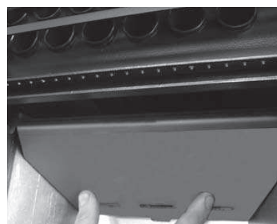
Fig. 14: soulever la plaque coupe-flamme
